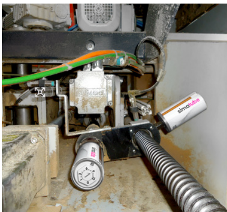
Die Spindel einer Kreissäge wird zuverlässig mit zwei simalube 125 ml geschmiert.
