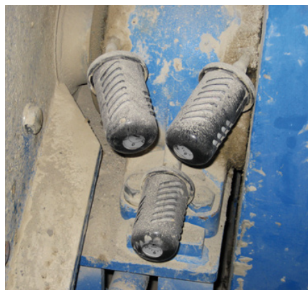
Die Schutzhauben verhindern Beschädigungen der automatischen Schmierstoffspender durch äussere Einwirkung.
