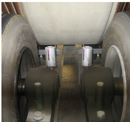
Die Spender sind direkt auf das Stehlager am Antrieb eines Förderbandes geschraubt und sorgen für eine konstante Schmierung.
