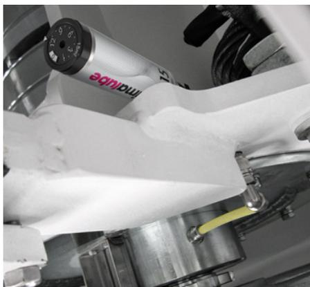
Même dans les espaces étroits, les plus petits graisseurs lubrifient avec fiabilité et précision.
