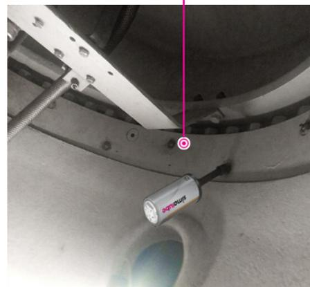
Graissage automatique utilisant le simalube de 125 ml sur une couronne d'orientation de pale de rotor.
