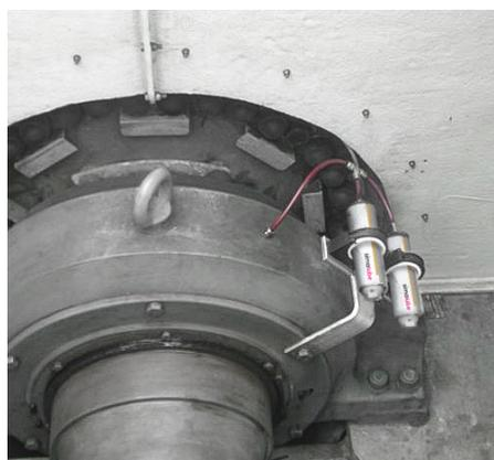
Deux graisseurs simalube de 250 ml graissent le palier principal d'une éolienne.
