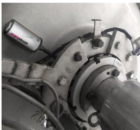
Avec les accessoires pratiques du simalube, il est facilement possible d'équiper chaque point de graissage avec un graisseur simalube.
