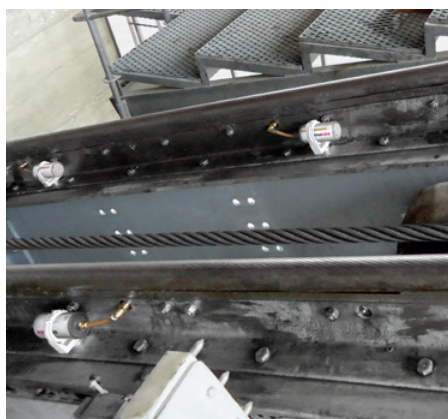
Plusieurs graisseurs sont montés sur un cavalier. Grâce au montage d'un collier de maintien magnétique les installations complexes sont contournées.
