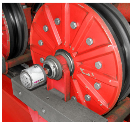
Les galets de guidage d'un téléphérique sont alimentés avec la dose de lubrifiant nécessaire.
