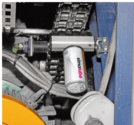
Le graisseur simalube alimente continuellement la chaîne en huile, même lorsque l'espace disponible est extrêmement limité. Dans le même temps, la brosse nettoie la chaîne.
