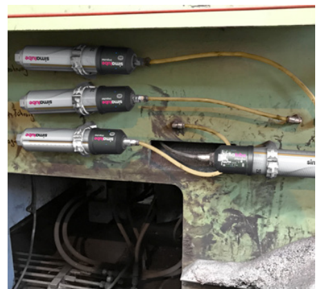
Gracias al amplificador de presión simalube IMPULSE, los puntos de lubricación de la bobinadora (rodamiento, casquillo, guía y engranaje) pueden montarse a distancia y hacen llegar el lubricante a través de una instalación de tubos.
