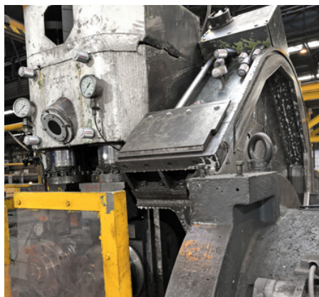
Varios lubricadores y pulsadores simalube lubrican las columnas (izquierda) y el accionamiento (derecha) del laminador.
