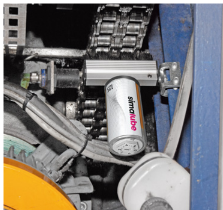
El lubricador simalube aplica aceite a la cadena de manera continua, también en espacios reducidos. Al mismo tiempo, el cepillo limpia la cadena.
