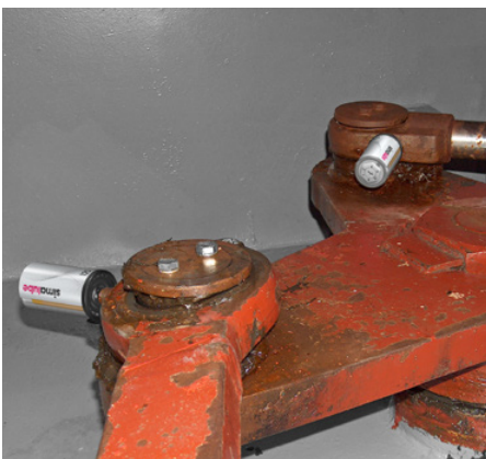
La rueda del timón es lubricada con dos simalube de 125 ml.
